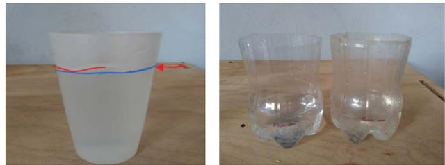
**Figura 27.** a) Delimitación de la cantidad de agua a emplear, b) Vertido en los reservorios de agua y marcado del nivel original
