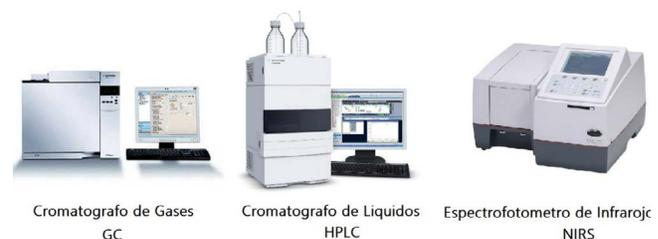
**Figura 13.** Equipos para caracterizar la calidad del biodiesel.
