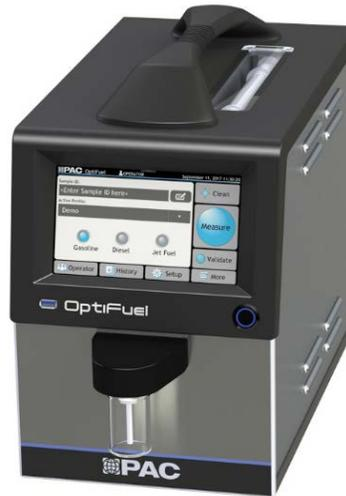
**Figura 14.** Equipo de infrarrojo (IR) OptiFuel.
