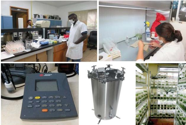
**Figura 1.** Materiales y equipos utilizados en un laboratorio de cultivo *in vitro*. 1. Mesas de trabajo, 2. Campana de flujo laminar, 3. Equipo para medir pH, 4. Autoclave, 5. Cuarto de cultivo.
