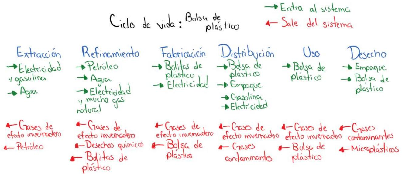
Figura 31. Diagrama del ciclo de vida de una bolsa de plástico.
