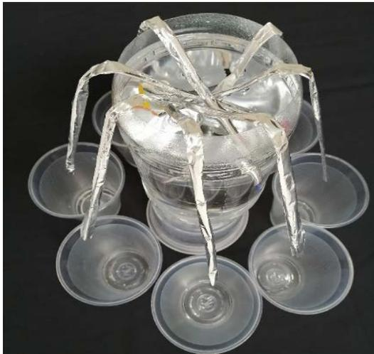
**Figura 15.** Montaje de los rollos en el contenedor de agua para la prueba de capilaridad.
