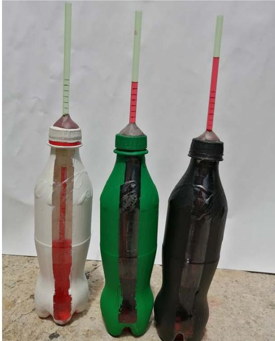
**Figura 35.** Prueba bajo el sol de los sistemas envase-líquido-popote de diferentes colores.
