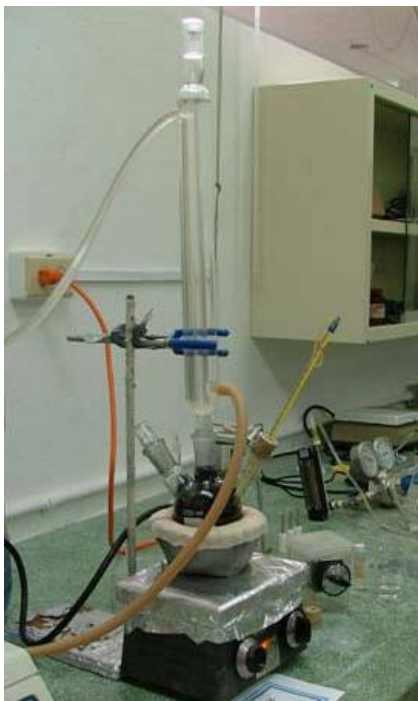
Figura 3. Sistema de producción de catalizadores para celdas de combustible.
