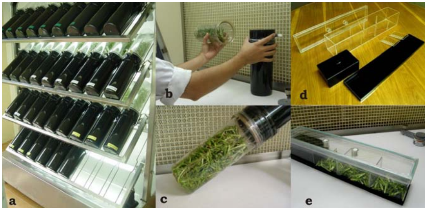
Figura 3. Nuevos métodos de cultivo: a, b y c) cultivo de henequén en biorreactores BioMINT; d y e) nuevo biorreactor de irrigación temporal.
