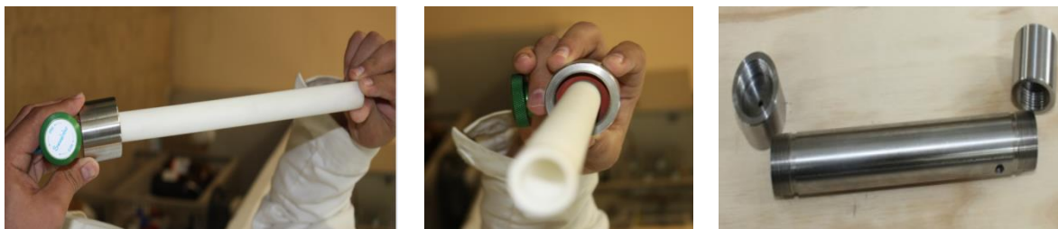
Figura 8. Módulo de membranas tubulares para separación de gases SENER 2013
