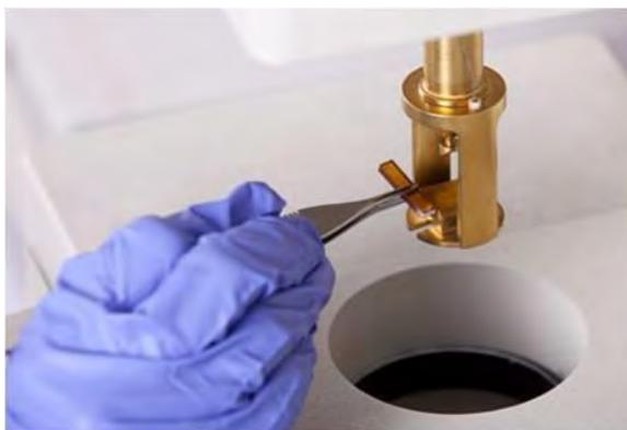
**Figura 5. Analizador dinámico mecánico. Celda de carga para flexión en tres puntos.**
