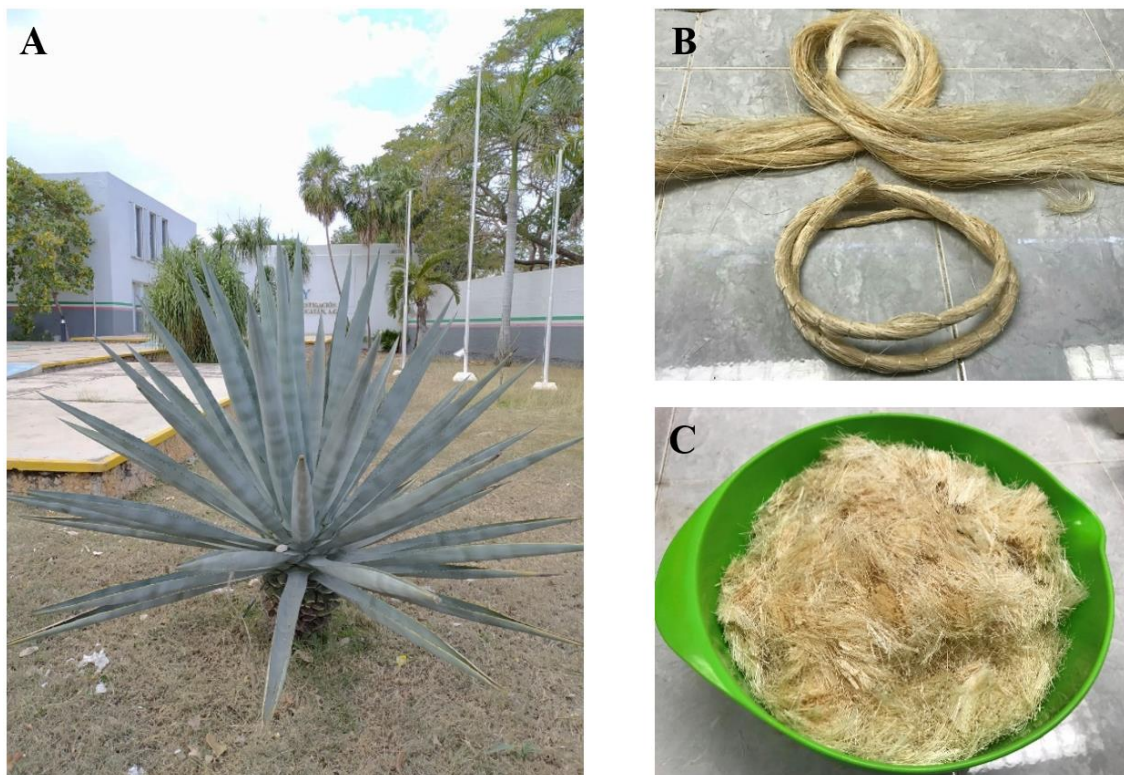
Figura 1. A. Planta de henequén ( Agave fourcroydes ). B. Fibras de henequén producidas en Yucatán. C. Fibras de henequén cortas para su uso como refuerzo en concreto espumado. (Fotografías: Joaquín Castillo y Emmanuel Flores).
