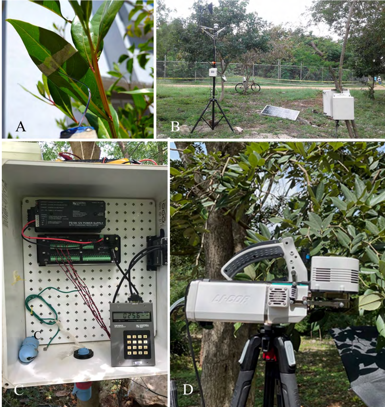
Figura 4. A. Detalle de un termopar (cables azules) instalados en una hoja. Mide la temperatura de la hoja durante el día y la noche. B. Estación con sensores microclimáticos (izquierda) y registrador de datos. C. Vista interna del registrador. D. Mediciones de fotosíntesis en árboles del parque “Animaya”. (Fotografías: A. Casanova, R. Us y G. Carrillo).
