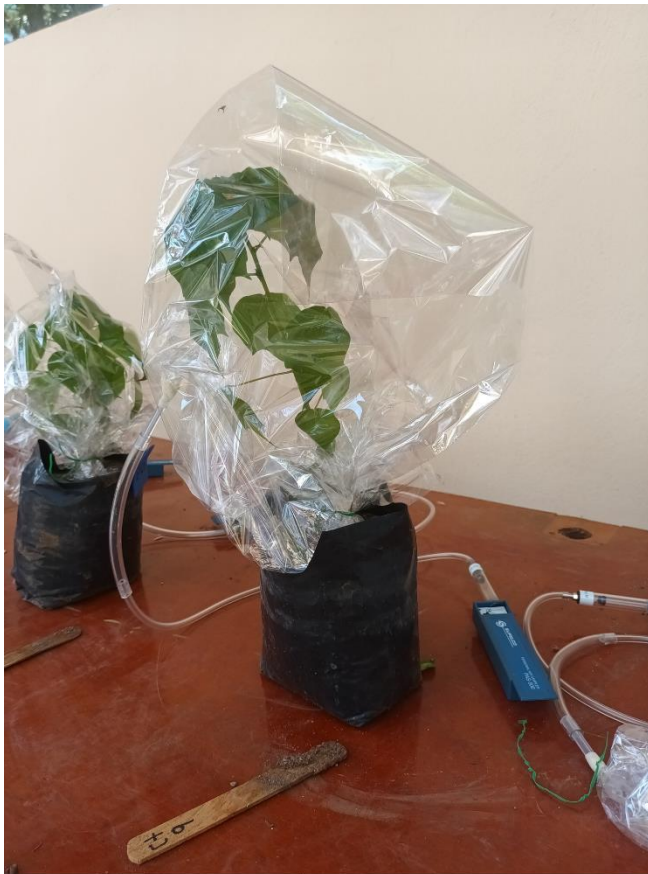
Figura 2. Instrumentos y metodología de colecta de metabolitos volátiles emitidos por el follaje de una planta de algodón silvestre ( Gossypium hirsutum L., Malvaceae) mediante bolsas inoloras de nalofán y bombas de absorción conectadas a filtros especiales donde quedan atrapados los compuestos. (Fotografía: Teresa Quijano Medina).
