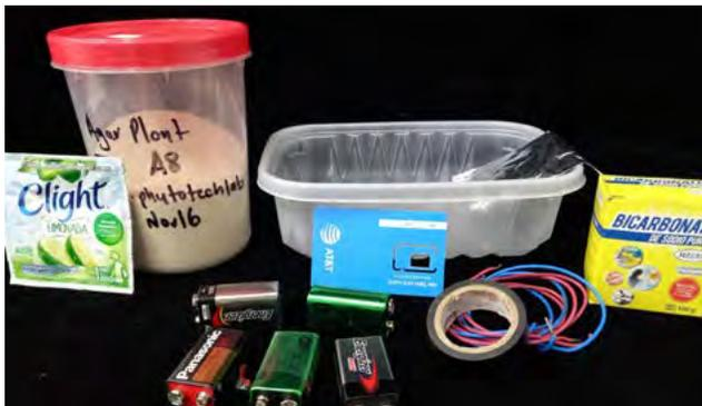
**Figura 5.** Material necesario para el armado de la cámara de electroforesis y su empleo.
