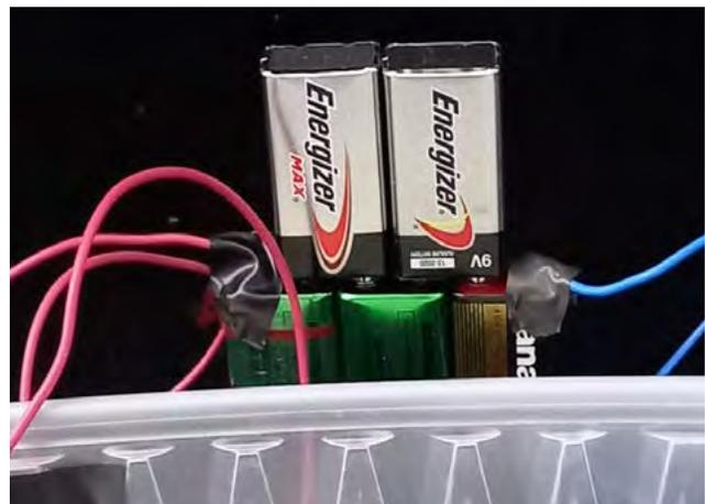
**Figura 6.** Armado de las pilas para proporcionar la energía de 45 V.
