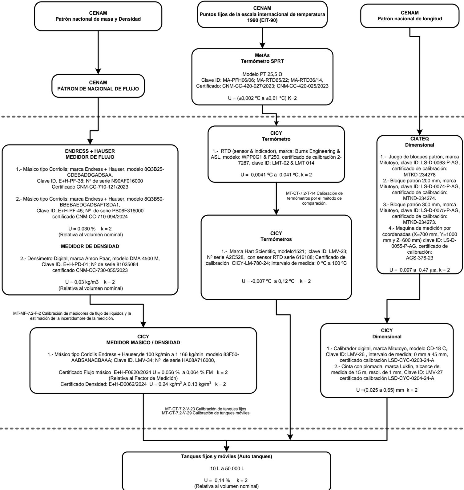
**Calibración de Tanques (Fijos y móviles)**
