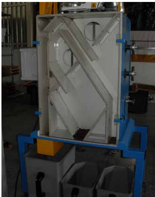
Figura 9. Aventadora eléctrica con ventilación. Fotografía: Francisco Chi.
