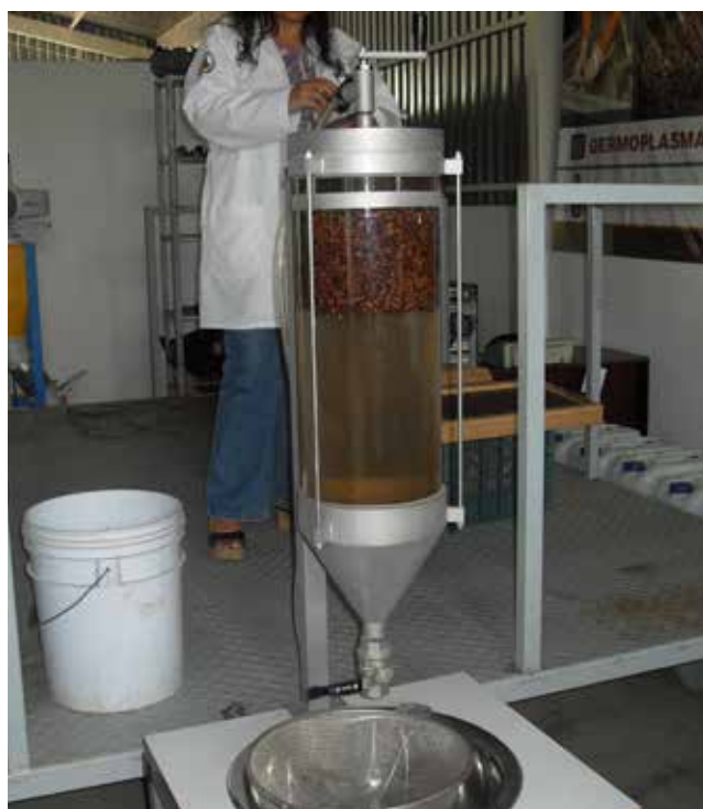
Figura 10. Limpieza por flotación. Fotografía: Francisco Chi.
