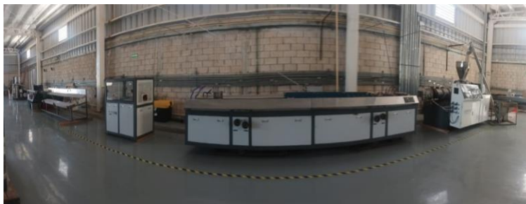
Figura 124. Línea de Extrusión de perfiles.
