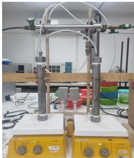
Figura 49. Módulos ensamblados con fibras huecas para su uso en purificación de agua.
