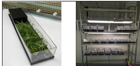
Figura 30 Biorreactores de Inmersión temporal patente CICY
